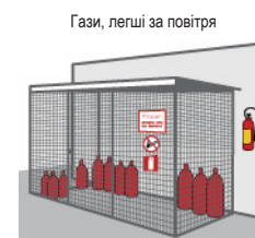
Мал. 10. Склад технічних газів на відкритому повітрі
