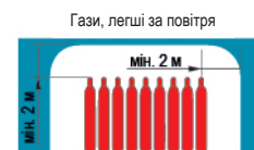
Мал. 8. Розміри захисних зон для балонів із горючим газом при зберіганні в будівлях
