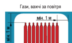
Мал. 11. Розміри захисних зон для балонів із горючим газом при зберіганні на відкритому повітрі
